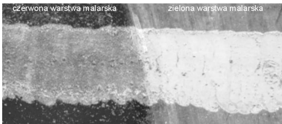
Rys. 8. Wpływ rodzaju warstwy malarskiej na proces usuwania werniksu: gęstość energii promieniowania laserowego 1,7 \text{ J/cm}^2
